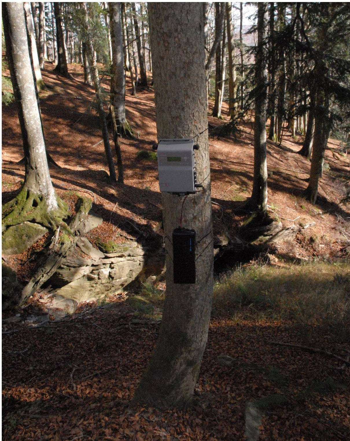
Fig. 1 - Registratore Wildlife Acoustics SM3 collocato ai margini di Pian dei Giusti, nel cuore della RNI. La batteria esterna consente il funzionamento per circa 90 giorni. In anni successivi sono stati affiancati i nuovi modelli SM4.
